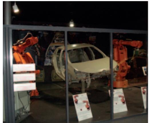
*Robots soudeurs d'un atelier Peugeot*
